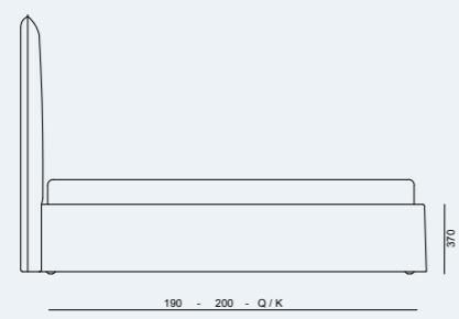
I disegni tecnici fanno riferimento al letto fornito con piedi standard. Al variare dei piedi variano anche l'altezza complessiva del letto e il piano d'appoggio del materasso. The production drawings are referred to the bed with standard feet. Any foot change will also imply a change of the height and of the mattress base.
