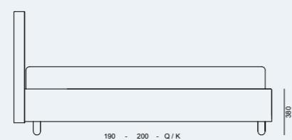
I disegni tecnici fanno riferimento al letto fornito con piedi standard. Al variare dei piedi variano anche l'altezza complessiva del letto e il piano d'appoggio del materasso. The production drawings are referred to the bed with standard feet. Any foot change will also imply a change of the height and of the mattress base.
